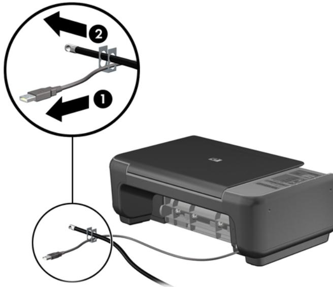
5. Pase los cables del teclado y del mouse a través del bloqueo de chasis del equipo.
