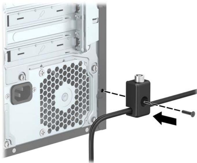
7. Inserte el extremo del cable de seguridad en el bloqueo (1) y presione el botón (2) para activar el bloqueo. Utilice la llave suministrada para desactivar el bloqueo.
