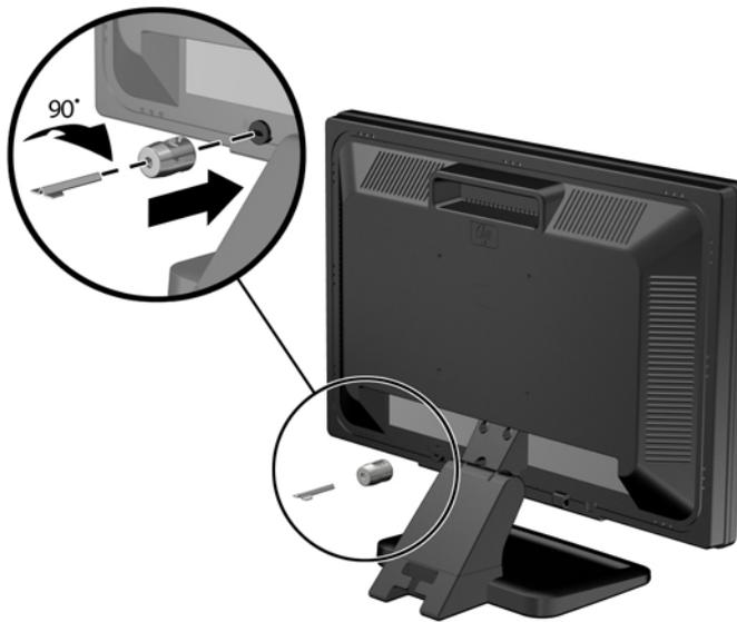
3. Deslice el cable de seguridad a través del orificio del cable de seguridad en la parte trasera del monitor.
