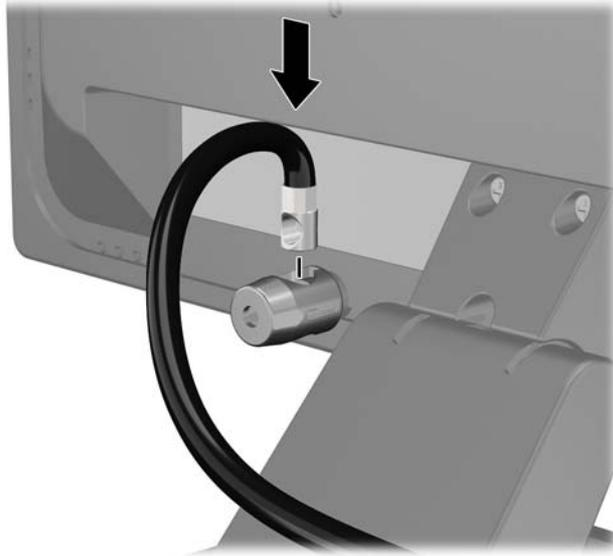
4. Utilice el soporte que se suministra en el kit para asegurar otros dispositivos periféricos, colocando el cable del dispositivo en el centro del soporte (1), e insertando el cable de seguridad a través de uno de los orificios en el soporte (2). Utilice el orificio en el soporte que mejor fije el cable del dispositivo periférico.
