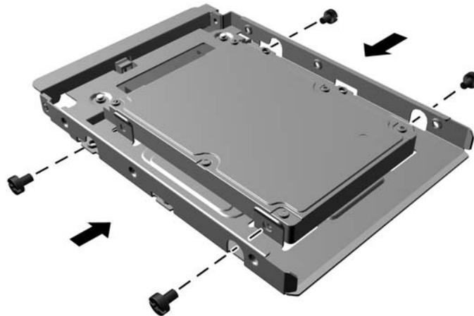
**7.** Instale cuatro tornillos de montaje, dos a cada lado de la unidad.
