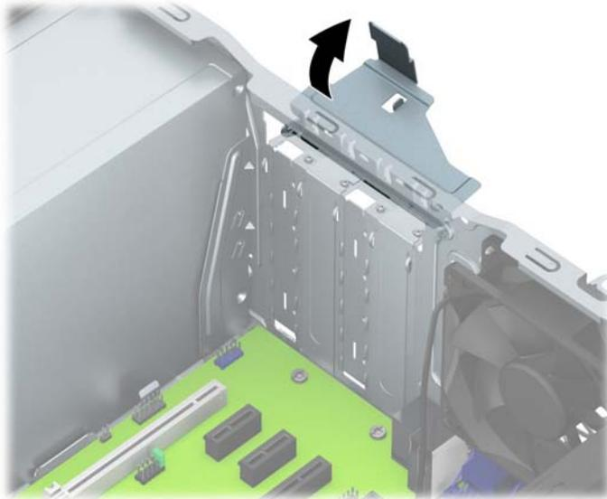
7. Ubique el socket vacío correcto en la placa del sistema y la ranura de expansión correspondiente en la parte trasera del chasis del equipo.
