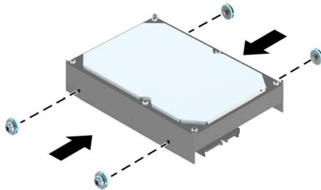
8. Deslice la unidad dentro del compartimiento, asegurándose de alinear los tornillos de montaje con las ranuras guía, hasta que la unidad encaje en su lugar.
