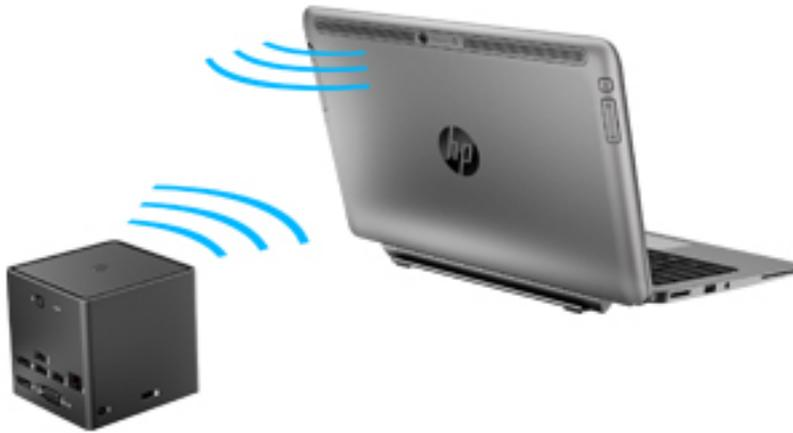
HP Wireless 无线坞站 (WiDock) 允许笔记本电脑通过其 WiGig 连接与已连接到坞站的设备，如键盘、显示器和其他显示屏，以及有线网络连接进行连接。
