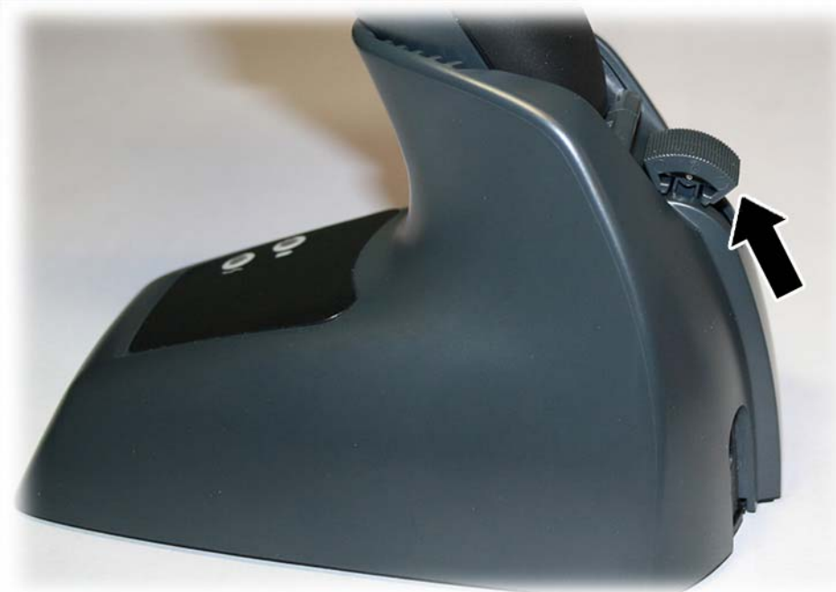
Figure 4-3 Levier en position verrouillée
