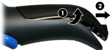
Figure 4-12 Extraction de la batterie
