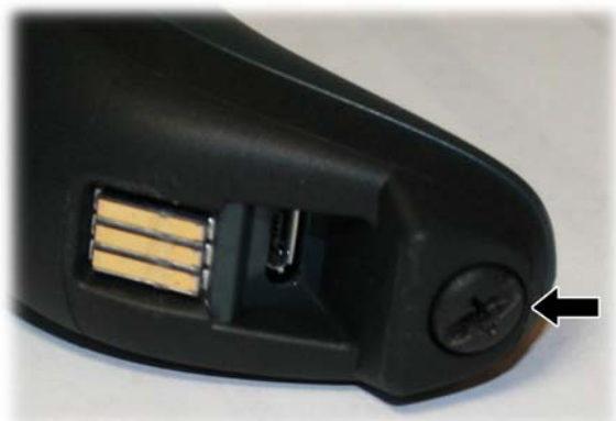
Figure 4-11 Vis de la batterie
