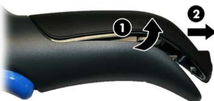
Figura 4-12 Extração do conjunto de baterias
