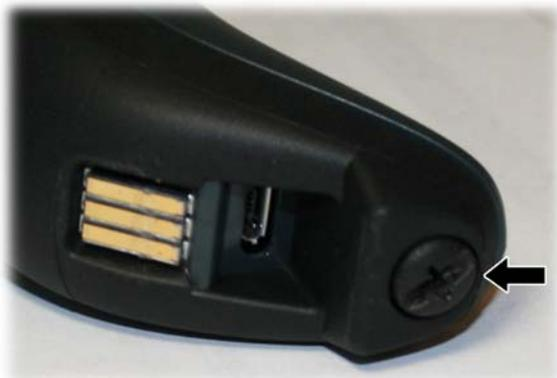
La batería se elevará ligeramente en la parte trasera, desplazada por los muelles de contacto.
