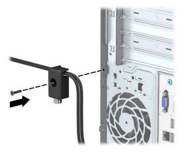
8. Inserire lo spinotto del cavo di sicurezza nel fermo (1) e premere il pulsante (2) per attivare il blocco. Per disattivarlo, utilizzare la chiave fornita.
