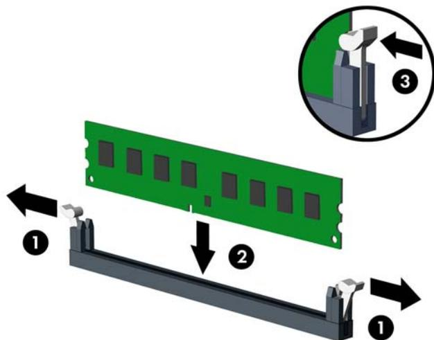
**注：** 内存模块只能以一种方式安装。将模块上的凹槽与内存插槽上的卡舌对准。
