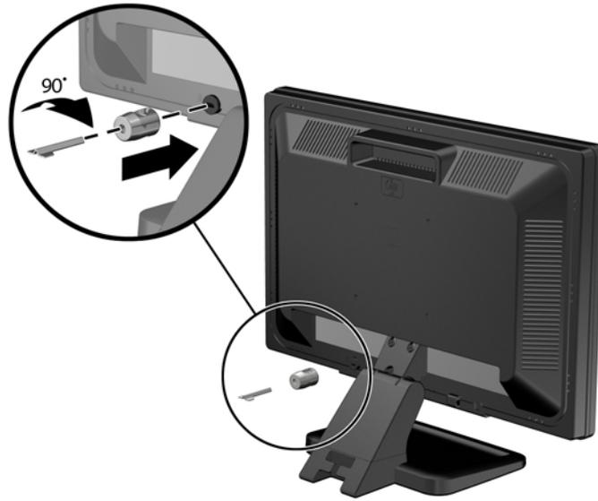
3. 将安全电缆穿过监视器背面的电缆锁孔。
