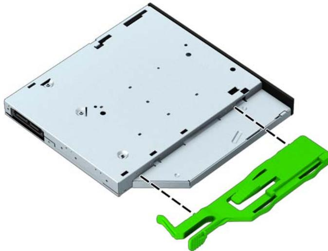
9. 将光驱通过前面板 (1) 径直推入托架中，以便绿色锁定器锁定到机箱框架 (2)。
