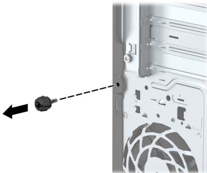
7. 使用附带的螺钉通过翼形螺钉孔将锁固定到机箱上。
