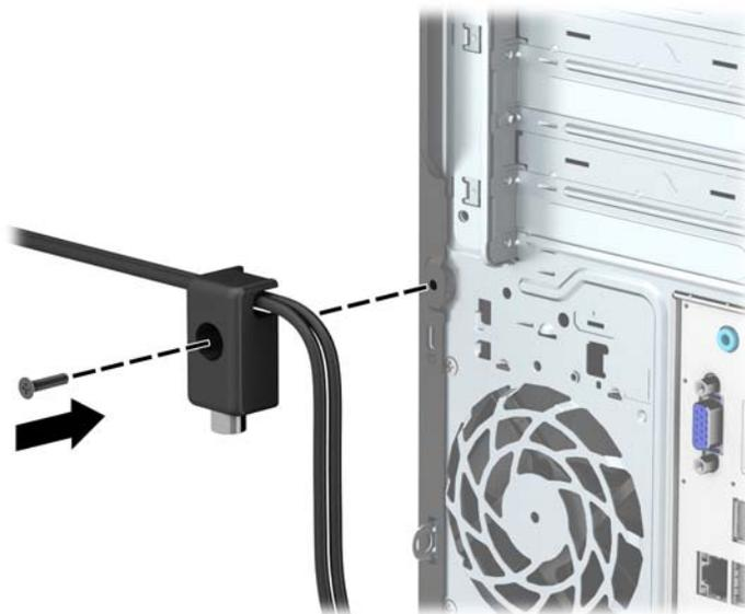
8. 将安全保护缆锁一端的插头插入钳锁中 (1)，然后按 (2) 所示方向推按钮以锁上钳锁。使用附带的钥匙可以打开该锁。
