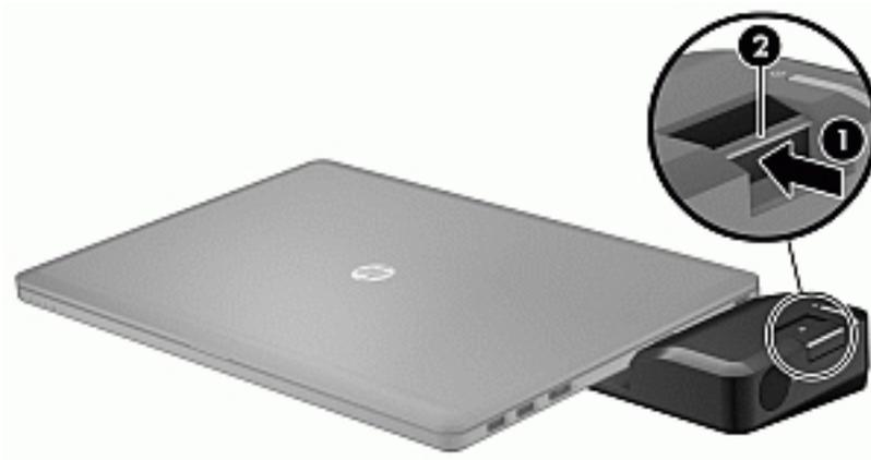
Para conectar un dispositivo de puerto de expansión al equipo:
