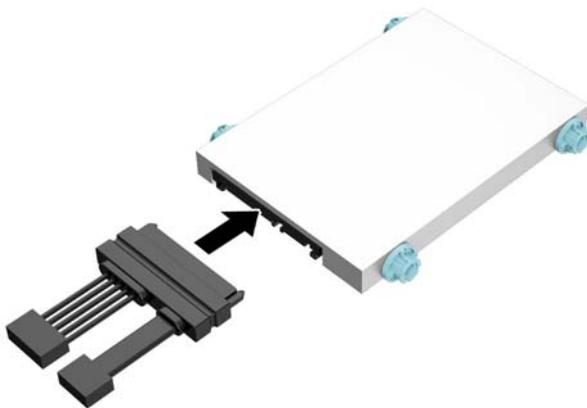
11. 将导向螺钉对准机箱驱动器机架上的插槽，并向下按硬盘驱动器使其进入托架，然后向后滑动驱动器直到滑不动且卡入到位为止。
