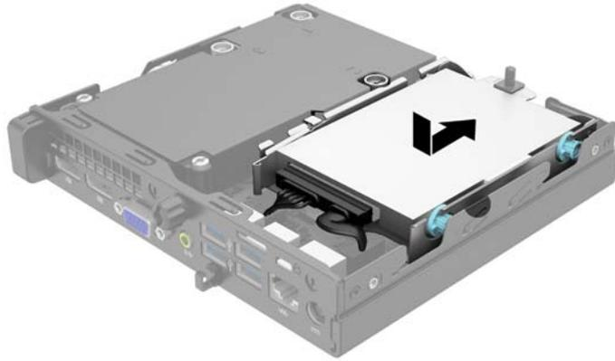
12. 将硬盘驱动器的电源电缆 (1) 和数据电缆 (2) 连接到主板上。
