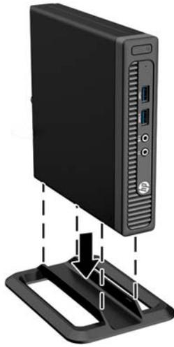
**📝 注：**为了使计算机在立式机配置下保持稳定，HP 建议您使用立式底座选件。
