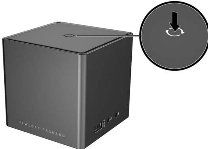
Die Wireless-Docking-LED blinkt weiß, während die Kopplung der Dockingstation durchgeführt wird. Nach erfolgreicher Kopplung leuchtet die LED durchgehend weiß.
