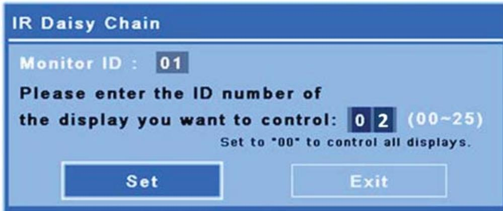
Drücken sie auf "Einstellen", um die eingegebene ID-Nummer auszuwählen und diesem Display Befehle zu senden. Die Sperr-Anzeige wird auf allen anderen Displays erscheinen, um anzuzeigen, dass sie keine Befehle der IR-Fernbedienung empfangen ([Abbildung 4-3, „Anzeige der IR-Sperre“ auf Seite 42](#)). Das OSD-Menü wird auf dem ausgewählten Display erscheinen. Jeder Befehl, jede Menüauswahl oder geänderte Einstellung wird nun von dem ausgewählten Display empfangen und ausgeführt.
