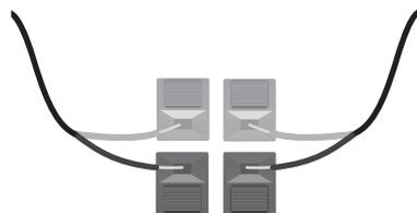
5. Wenn Sie das Display über die RS-232-Schnittstelle steuern möchten, verbinden Sie das eine Ende eines RS-232-Kabels mit dem RS-232-Eingabe (5) (Wenn das Display mit der Bildschirmseite nach unten liegt, befindet sich die Eingabebuchse unter der Ausgangsbuchse) und verbinden Sie das andere Ende mit der seriellen Schnittstelle des Medienplayers/Computers.
