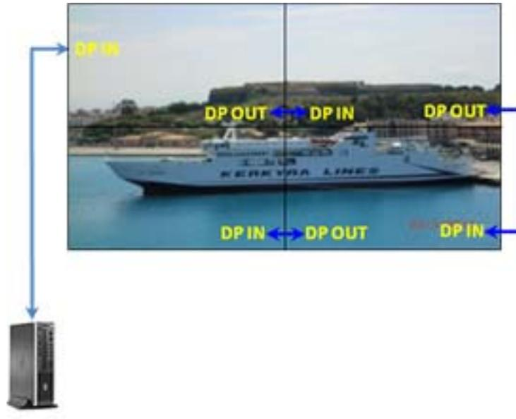
**Abbildung 3-35** Daisy Chain-Verbindung – DisplayPort
