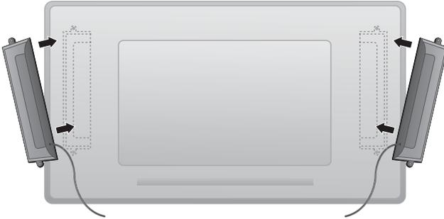
2. Verwenden Sie die vier Taptite-Schrauben (D3 x 12 mm ), um die Lautsprecher am Display zu sichern.
