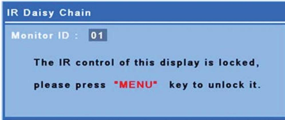
Wenn Sie die MENU-Taste auf der IR-Fernbedienung drücken, verlassen Sie den IR-Daisy-Chain-Modus und die Sperre auf allen Displays wird aufgehoben.
