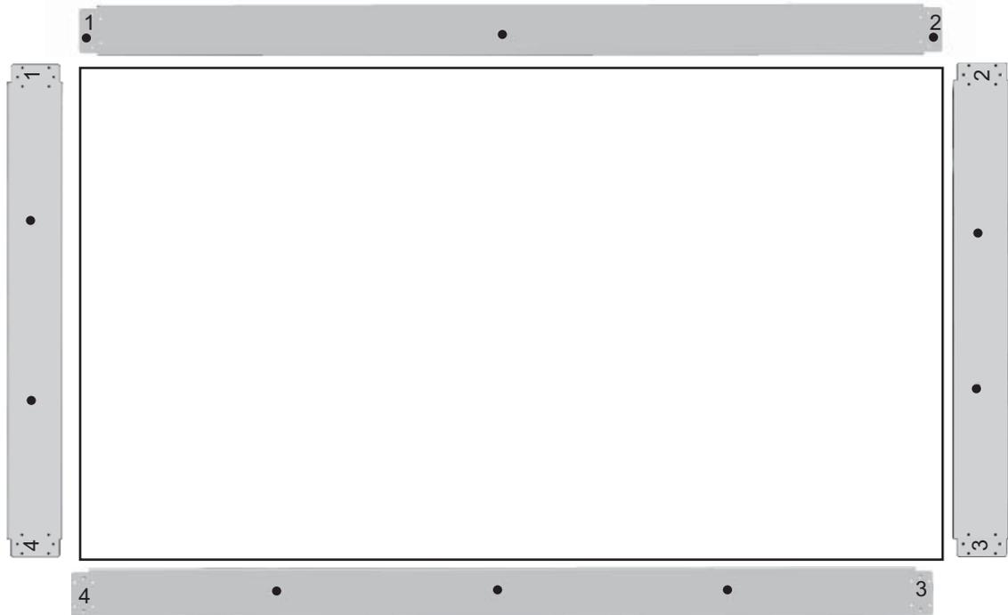
Um ein einzelnes Display einzurahmen, befestigen Sie die Oberseite des Displays mit vier der beiliegenden breiten (M4 x 10 mm) Schrauben. Die Schiene überlappt die Blende des Displays. Befestigen sie die untere, linke und rechte Schiene auf die selbe Weise, lassen Sie die kleinen Löcher an jedem Ende offen.
