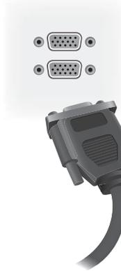
Verbinden Sie das freie Ende des VGA-Kabels mit dem Mediaplayer/Computer oder dem vorherigen Display.
