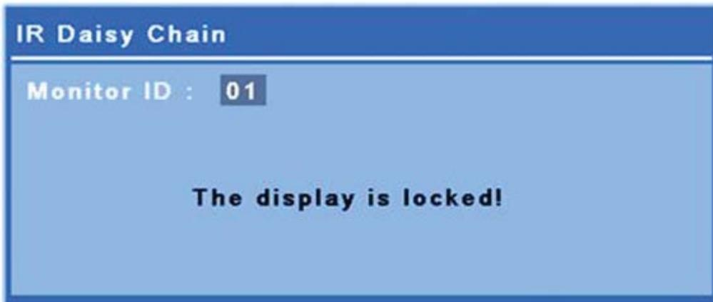
Nach einer kurzen Zeitspanne wird die Anzeige der IR-Sperre von den Displays verschwinden. Sie können jederzeit die INFO-Taste auf der IR-Fernbedienung drücken und die Anzeige der IR-Sperre wird auf den gesperrten Displays erscheinen.
