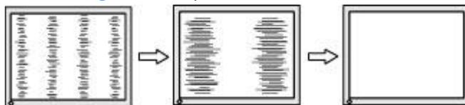
6. Navigieren Sie zu **Taktrate**. Erhöhen oder verringern Sie den Wert, um Flimmern und Verschwimmen von Videobildern zu minimieren.
