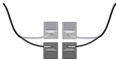
5. Si vous souhaitez contrôler à distance et gérer l'écran avec l'interface Série RS-232, fixez l'extrémité d'un câble RS-232 à l'entrée du port d'entrée RS-232 (5) (avec l'écran posé face au sol, le port d'entrée se situe en dessous du port de sortie) et connectez l'autre extrémité au port d'interface série du lecteur médias/ordinateur.
