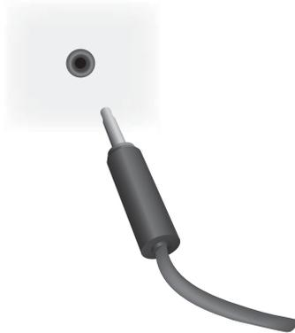
**REMARQUE :** Le coeur en ferrite peut être utilisé pour réduire les ondes électromagnétiques lors de la connexion d'un câble audio. Adaptez le coeur en ferrite au câble audio. Le coeur en ferrite doit être distant de 5 cm du moule.
