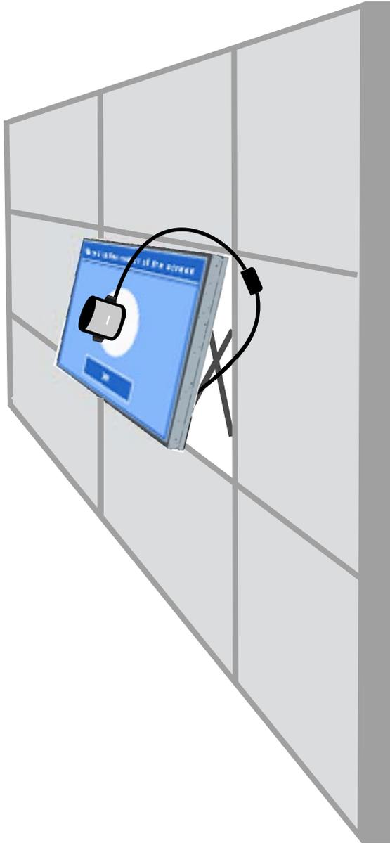
8. Ajustez la position du contrepois pour que le colorimètre soit correctement positionné et reste en place lorsqu'il est relâché. Pour ajuster la position du contrepois sur le câble USB, appuyez sur le bouton de déverrouillage et faites glisser le poids.
