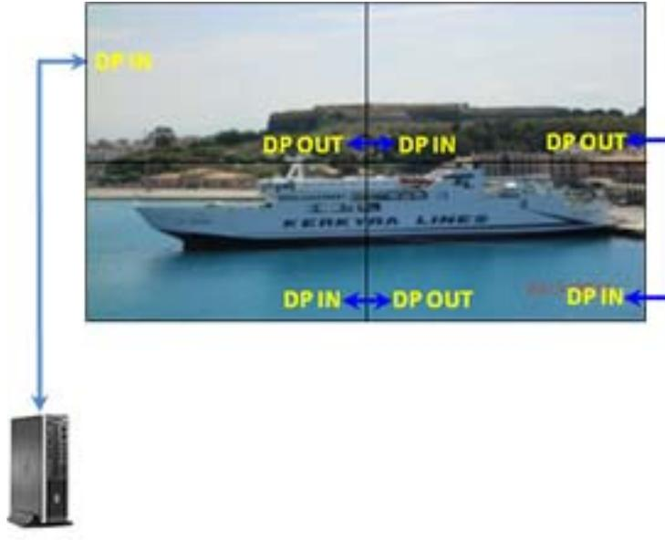
**Figure 3-35** Connexion en chaîne : Display Port
