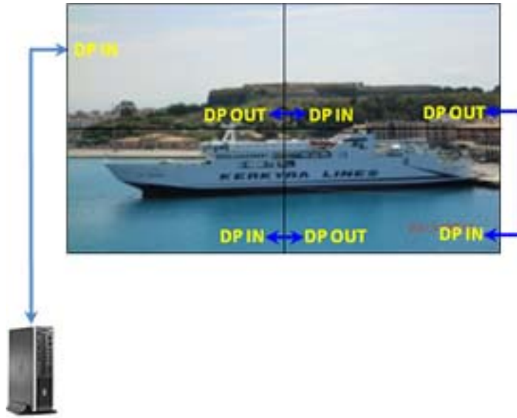
Εικόνα 3-34 Πολλαπλές οθόνες με λειτουργία παράθεσης
