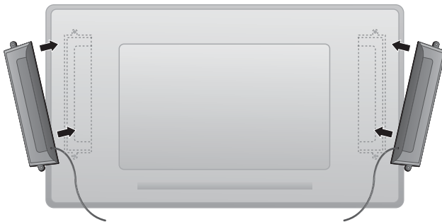
Figura 3-2 Montagem dos alto-falantes
