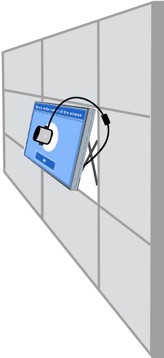
Afbeelding 4-11 De colorimeter positioneren
