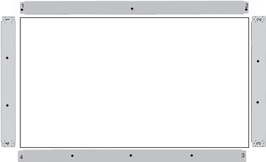
단일 디스플레이의 프레임을 만들려면, 제공된 큰(M4 x 10mm) 나사 3개를 사용하여 디스플레이의 상단에 상단 레일을 부착합니다. 레일은 디스플레이의 베젤이 겹쳐지게 합니다. 하단, 좌, 우 레일을 같은 방법으로 부착하고, 각 끝에는 두 개의 작은 구멍을 남겨둡니다.
