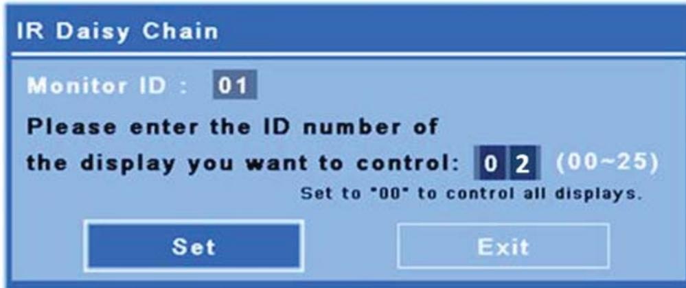
SET(설정) 버튼을 누르고 명령을 전송하려는 디스플레이와 같은 디스플레이 ID 번호를 선택합니다. 외부 IR 센서를 통해 IR 리모컨에서 명령을 수신하지 않는다는 표시로 다른 모든 디스플레이에 LOCK(잠금) 메시지 창이 표시됩니다(42페이지의그림 4-3 IR 잠금 메시지). 선택한 디스플레이에 OSD(On-Screen Display) 메뉴가 표시됩니다. IR 리모컨을 통해 입력한 명령, 메뉴 선택 또는 설정이 선택한 디스플레이를 통해 실행됩니다.
