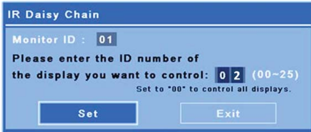
Figura 4-2 Identificación del monitor para controlar
