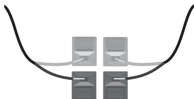
Figura 3-21 Conexiones de altavoces externos
