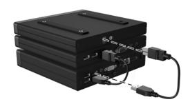
HINWEIS: Verbinden Sie beim zweiten Modul für Dockinglösungen das USB-Kabel mit dem anderen USB-Anschluss auf der Rückseite des Desktop Mini, der über erhöhte Leistung verfügt (mit einem weißen oder einem geprägten Umriss um das USB-Anschluss-Paar).
