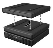
Schrauben Sie eine der 54-mm-Sicherungsschrauben (mit einem Torx-T15-Schraubenzieher oder einem manipulationsgeschützten und ausfallsicheren Schlüssel) durch die Module für Dockinglösungen hindurch in den Desktop Mini.
