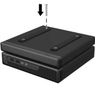
HINWEIS: Im Kit sind zwei Typen von Sicherungsschrauben enthalten: eine mit einem Torx-Schraubenkopf und eine weitere mit einem manipulationsgeschützten Schraubenkopf. Ein manipulationsgeschützter und ausfallsicherer Schlüssel ist bei HP verfügbar (PN 166527-001 oder 166527-002).
