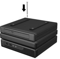
HINWEIS: Im Kit sind zwei Typen von Sicherungsschrauben enthalten: eine mit einem Torx-Schraubenkopf und eine weitere mit einem manipulationsgeschützten Schraubenkopf. Ein manipulationsgeschützter und ausfallsicherer Schlüssel ist bei HP verfügbar (PN 166527-001 oder 166527-002).
