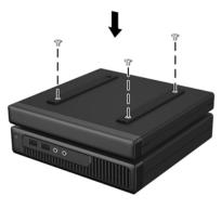
HINWEIS: Im Kit sind zwei Leiterschrauben-Serien enthalten. Schrauben Sie den kürzeren 4-mm-Satz in das Modul für Dockinglösungen.
