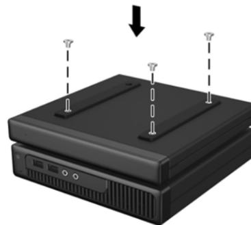
**2** Placez les fentes de montage au dessus du module d'extension, au dessus des vis à têtes relevées et faites glisser le module d'extension vers l'arrière.
