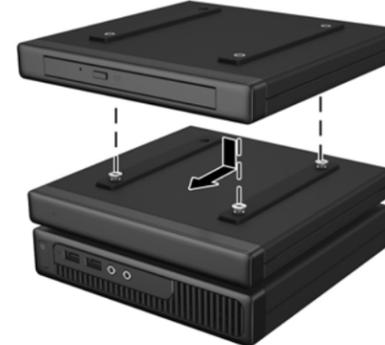
**3** Installez l'une des vis de sécurité de 54 mm (en utilisant un tournevis Torx T15 ou une clé de sécurité inviolable) sur le module d'extension et le Desktop Mini.
