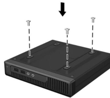
**2** Posizionare le aperture sulla parte superiore del modulo di espansione sopra le viti cieche e far scorrere all'indietro il modulo di espansione.
