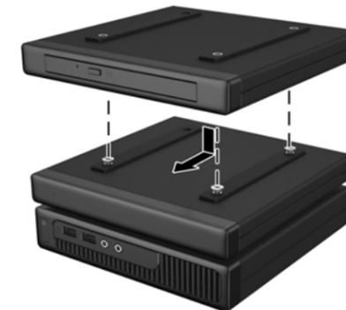
**3** Installare una delle viti di sicurezza da 54 mm (utilizzando un cacciavite Torx T15 o una chiave fail-safe antimanomissione) sul Desktop Mini, passando attraverso i moduli di espansione.
