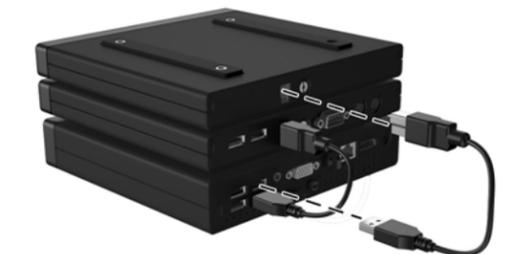
**NOTA:** il kit include due set di viti cieche. Installare il set più corto da 4 mm sul modulo di espansione.
