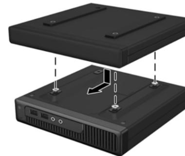
**3** Installare una delle viti di sicurezza da 29 mm (utilizzando un cacciavite Torx T15 o una chiave fail-safe antimanomissione Torx T15) sul Desktop Mini, passando attraverso il modulo di espansione.
