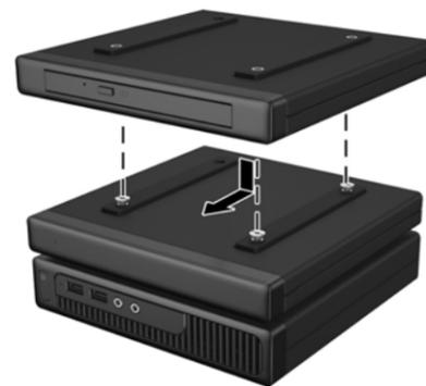
**3** 将其中一个 54mm 安全保护螺钉（使用 T15 梅花螺丝刀或防撬防故障钥匙）穿过扩展模块安装到微型台式电脑上。
