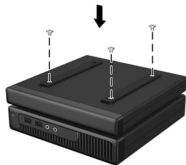
**注：** 此套件提供了两组梯形螺钉。将较短的 4mm 螺钉安装在扩展模块上。
