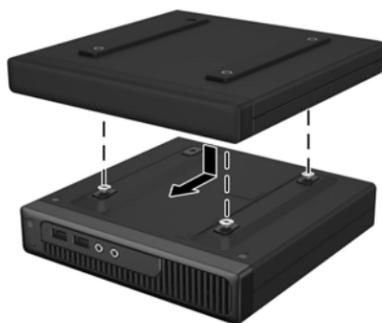
**3** 将其中一个 29mm 安全保护螺钉（使用 T15 梅花螺丝刀或 T15 梅花防撬防故障钥匙）穿过扩展模块安装到微型台式电脑上。
