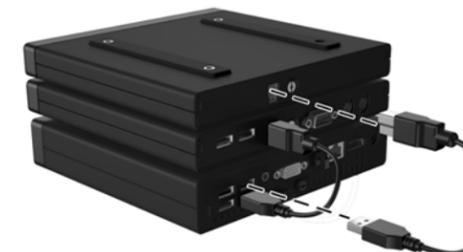
**注：** 对于第二个扩展模块，请将 USB 电缆连接到微型台式电脑的其他具有增强型功率的后部 USB 端口（USB 端口对周围带有白色或浮雕轮廓）。
