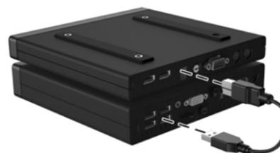
**注：** 将 USB 电缆连接到微型台式电脑的具有增强型功率的后部 USB 端口（USB 端口对周围带有白色或浮雕轮廓）。对于不具有增强型功率的微型台式电脑（800 G1、600 G1、705 G1），请将 USB 电缆连接到后部任一 USB 3.0 端口。
