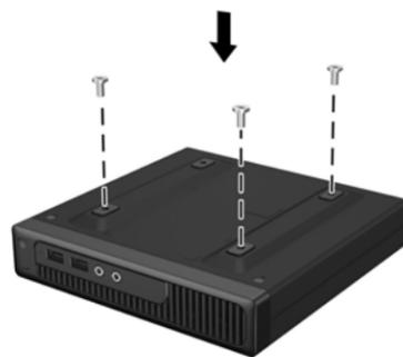
**注：** 此套件提供了两组梯形螺钉。将较长的 8mm 螺钉安装在微型台式电脑上。
