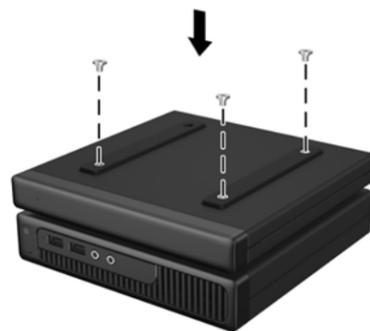
**2** 將擴充模組頂部的鎖孔插槽置於梯形螺絲上，再將擴充模組向後滑動。
