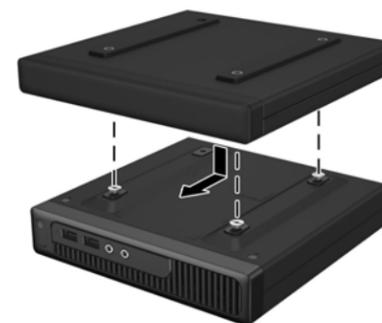
**3** Pasang salah satu sekrup pengaman 29mm (menggunakan sekrup Torx T15 atau kunci FailSafe Torx T15 anti-perusakan) melalui modul ekspansi dan ke dalam Desktop Mini.
