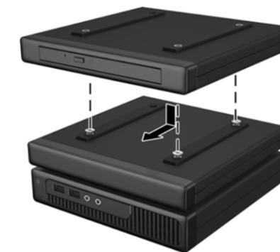
**3** Pasang salah satu sekrup pengaman 54mm (menggunakan obeng Torx T15 atau kunci FailSafe anti-perusakan) melalui modul ekspansi dan ke dalam Desktop Mini.
