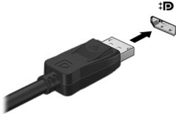
2. 将这根电缆的另一端连接到数字显示设备。
