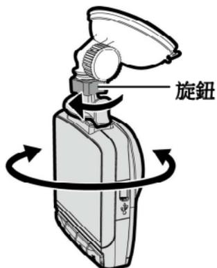
3. 鎖緊旋鈕，並確認設備已牢牢固定。
