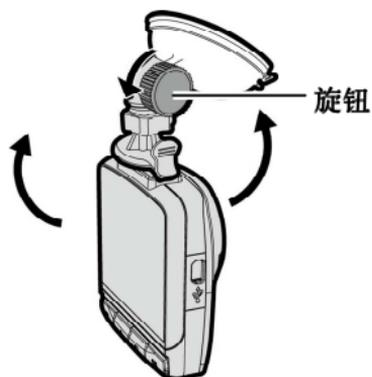
2. 松开旋钮，将设备水平方向调整 (360度)。
