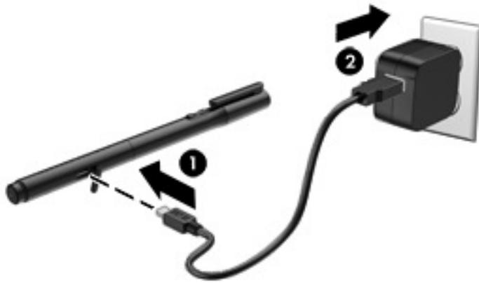
1. Temukan penutup karet (tercetak dengan USB logo) pada barrel pena, angkat perlahan penutup karet, lalu pasang kabel USB mikro (1) yang disertakan dengan tablet Anda ke pen.
