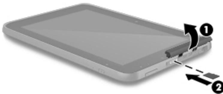
3. Presione con suavidad la tarjeta hasta que encaje firmemente.
