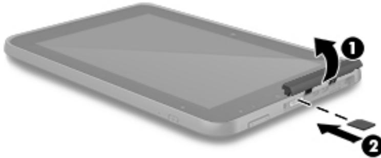
3. Presione con suavidad la tarjeta hasta que encaje firmemente.
