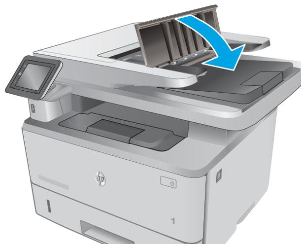
7. Abra a tampa do scanner. Se o papel estiver atolado na tampa do scanner, puxe-a para fora com cuidado e, em seguida, feche a tampa do scanner.
