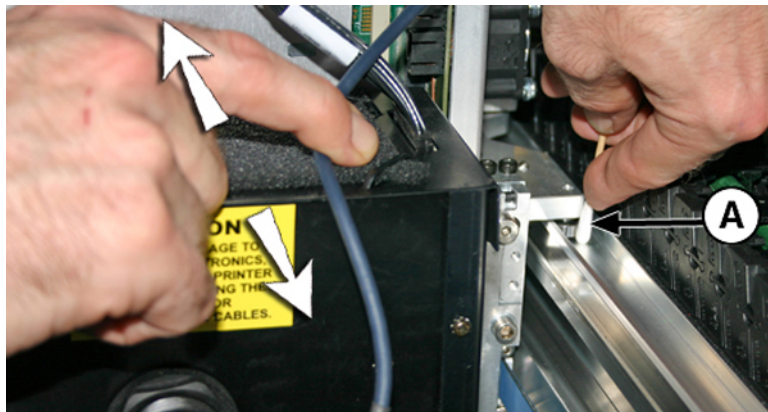
Figura 15 Limpieza de la rueda del carro con un hisopo de algodón
