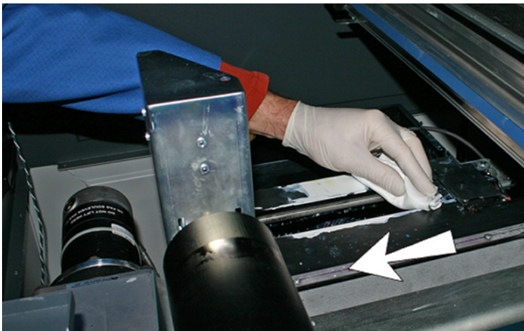
Figura 10 Limpieza de la parte superior de la estación de servicio
