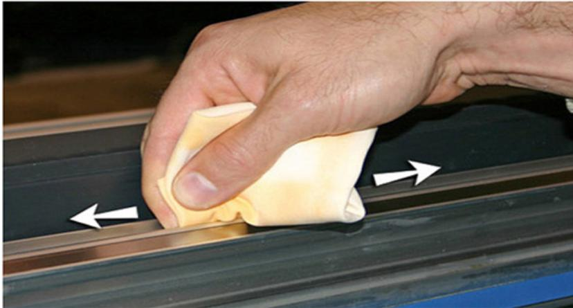
7. Utilice un paño sin pelusas con alcohol isopropílico y limpie la correa inferior de las ruedas del carro de extremo a extremo del riel (moviendo el carro con la mano para limpiar todo el riel).
