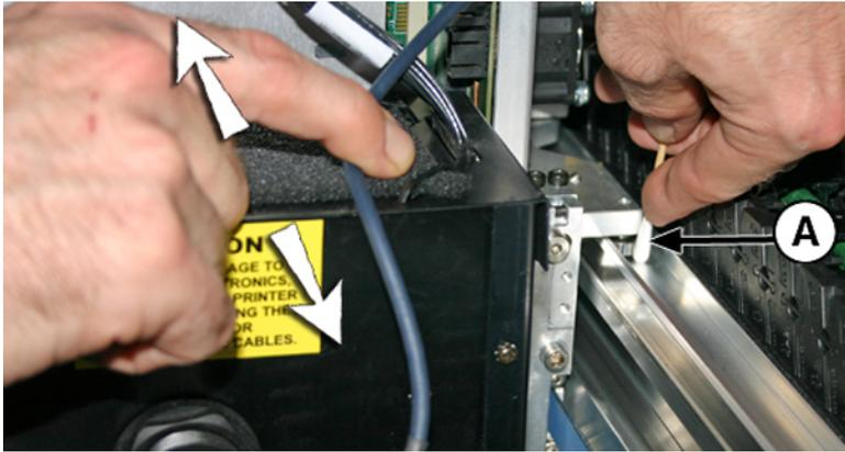
6. Limpie las ruedas superiores inclinadas; para ello, inserte un hisopo de algodón humedecido con alcohol isopropílico en la abertura que se encuentra sobre las ruedas (A) y mueva el carro hacia delante y hacia atrás. Realice el mismo proceso para cada rueda situada en los extremos del usuario y de servicio del carro.
