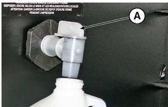
**⚠ PRECAUCIÓN:** El tapón de drenaje debe permanecer cerrado durante el proceso de impresión y el uso de la estación de servicio. Un tapón abierto afecta al nivel de vacío de la estación de servicio y degradará el rendimiento de la estación de servicio si se queda abierto.
