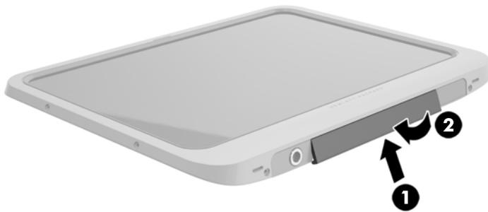
2. Presione la cubierta a cada lado, así como en la parte central, para asegurarse de que esté bien sellada. Confirme visualmente que está completamente cerrada.
