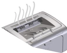
**HINWEIS:** Dieser Drucker leitet Wärme durch konvektive Kühlung ab. Die beim Druckvorgang entstehende Wärme und Feuchtigkeit wird durch Schlitze im Druckergehäuse oder durch das Ausgabefach abgeleitet.
