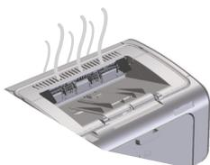
**NOTA:** Este produto dissipa calor com o uso do resfriamento convectivo. O calor e a umidade gerados pelo processo de impressão escapam pelos orifícios no exterior do produto ou pela área do compartimento de saída.
