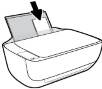
4. Deslice la guía de ancho del papel hacia la derecha hasta que llegue a la pila de sobres.
