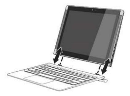
• Um das Tablet aus der Tastaturbasis zu entfernen, heben Sie eine Ecke (1) des Tablets an, um es zu lösen.
