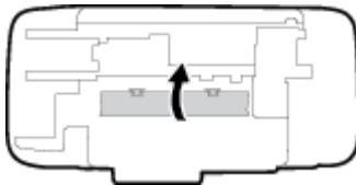
5. Preokrenite pisač i pritisnite gumb **Napajanje** (power button) da biste uključili pisač.
