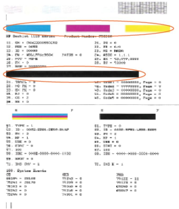
7. Očistite spremnike s tintom ako su na stranici za dijagnostiku vidljive pruge ili ako u okvirima u boji i crnim okvirima nedostaju dijelovi boje.
