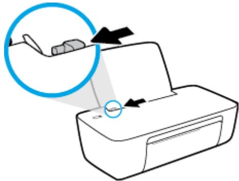
3. 将一个或多个信封紧靠进纸盒的最右侧放入，然后向下滑动整叠信封，直到不能移动为止。
