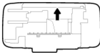
4. 合上顶盖。轻轻地朝打印机方向推上舱门，直到两者咬合到位。
