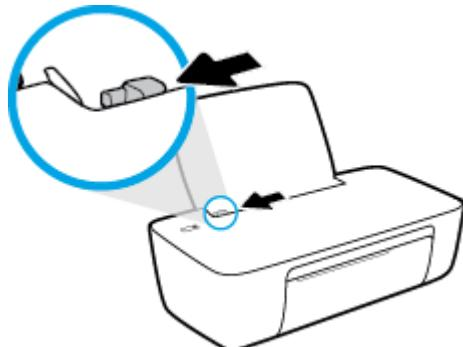
3. 将一叠照片纸放入进纸盒的最右边，短边朝下、打印面朝上，然后向下滑动纸叠，直到不能移动为止。
