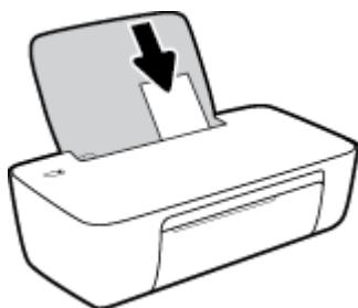
4. 向右滑动纸张宽度导轨，直到触及纸张边缘。
