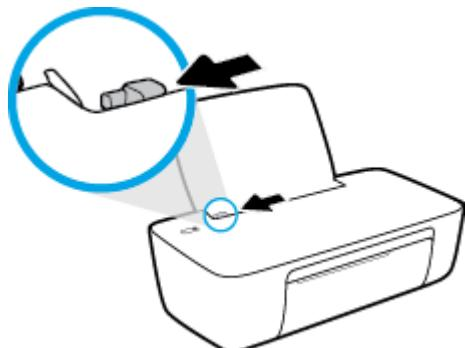
3. 将一叠纸短边朝下、打印面朝上放入进纸盒中，向下推纸叠，直到遇阻为止。
