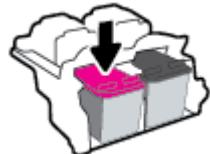
4. カートリッジの接触部分とプリンターの接触部分をクリーニングします。
