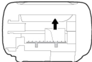
5. アクセス ドアを閉じます。ラッチが両方とも固定されるまで、ドアをプリンターの方向にゆっくりと押して閉じます。
