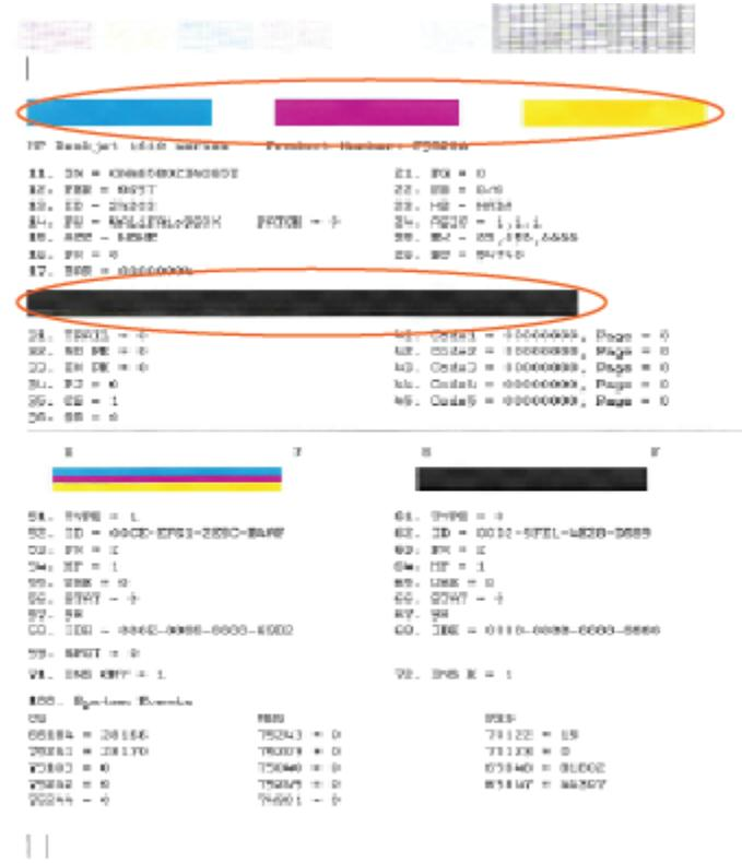
7. 診断ページのカラーおよび黒のボックスに線が入っていたり、ボックス内に印刷されていない箇所がある場合は、インクカートリッジのクリーニングを実行します。
