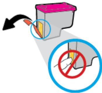
**注記 :** インク カートリッジの電気接触部には触らないでください。
