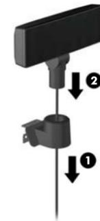
5. ポールを使用してVFDを取り付ける場合は、希望するVFDの高さに応じて、1本または2本のポールを設置ブラケットの上に差し込みます。次に、つなげたポールの上からVFDケーブルを入れて設置ブラケットの下部から出し①、ポールの上にVFDを差し込みます②。
