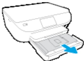
Якщо лотка для фотографій не видно, вийміть вихідний лоток із принтера.
