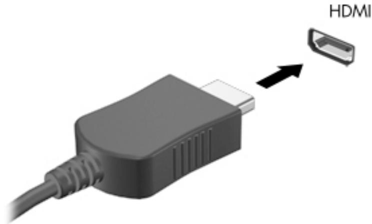
2. Hubungkan ujung lain kabel ini ke monitor atau TV definisi tinggi.
