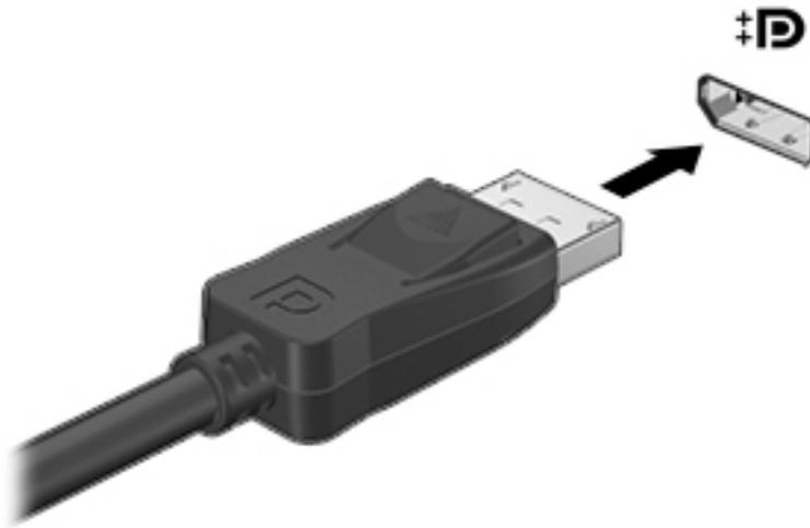
2. Hubungkan ujung lain kabel ini ke perangkat tampilan digital.
