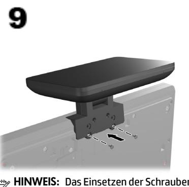
**HINWEIS:** Das Einsetzen der Schrauben ist ein erforderlicher Schritt.
