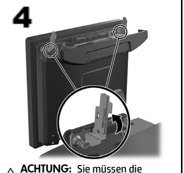
**ACHTUNG:** Sie müssen die Antennenhalterung hochdrehen, um die Frontblende zu entfernen.
