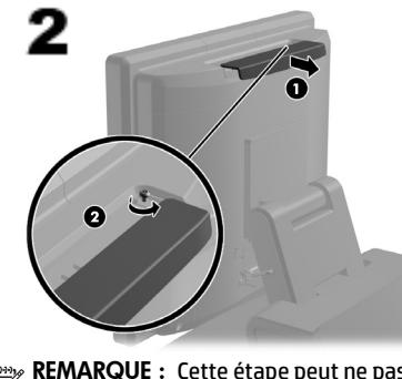
**REMARQUE :** Cette étape peut ne pas être nécessaire si la vis de sécurité est déjà dévissée.
