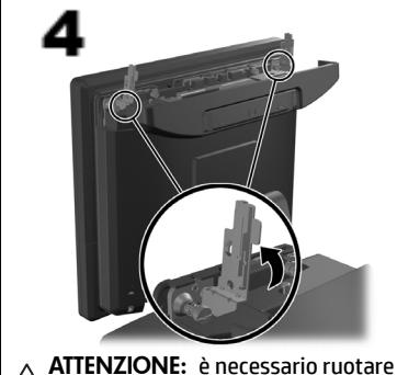
ATTENZIONE: è necessario ruotare verso l'alto le staffe antenna per rimuovere il pannello anteriore.
