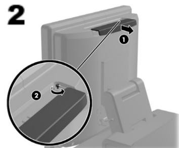
**NOTA:** Este paso puede no ser necesario si el tornillo de seguridad ya se ha aflojado.
