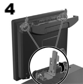
**PRECAUCIÓN:** Debe girar los soportes de la antena para retirar el panel frontal.
