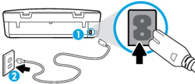
1 Conexão de força à impressora
