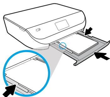
Inserte la pila de papel, ajuste las guías y empuje la bandeja hacia adentro.
