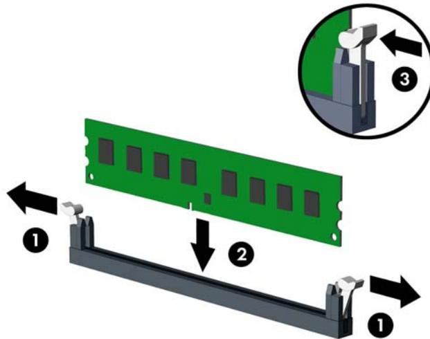
**NOTA:** El módulo de memoria se puede instalar de una sola manera. Haga coincidir la muesca del módulo con la lengüeta del socket de memoria.
