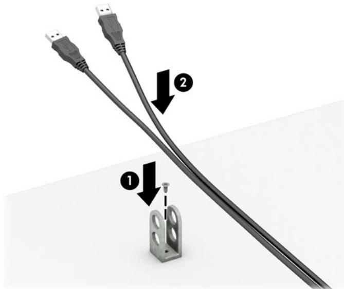
7. Deslice el cable de seguridad a través de los orificios del sujetador del cable de accesorios.
