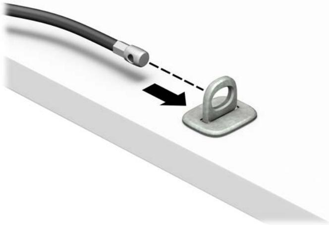
4. Separe los dos brazos de tijera del bloqueo del monitor e inserte el bloqueo en la ranura de seguridad de la parte trasera del monitor (1), cierre los brazos de tijera para fijar el bloqueo en su posición (2) y luego deslice la guía de cable a través del centro del bloqueo del monitor (3).
