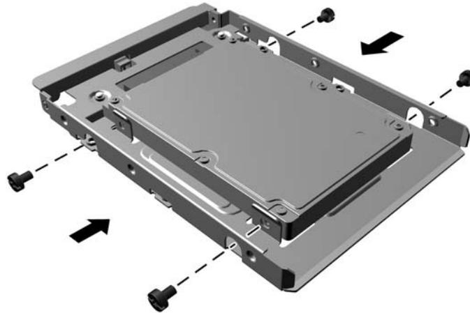
7. Instale los cuatro tornillos de montaje en los laterales de la unidad de 3,5 pulgadas o el soporte del adaptador de unidades de 2,5 pulgadas (dos a cada lado).
