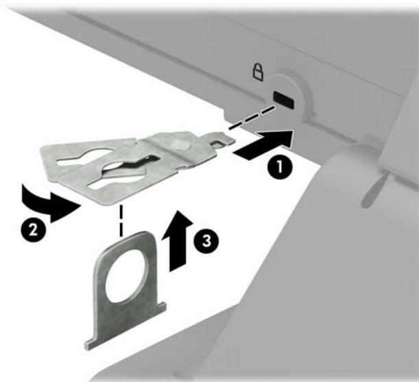
5. Deslice el cable de seguridad a través de la guía de seguridad instalada en el monitor.
