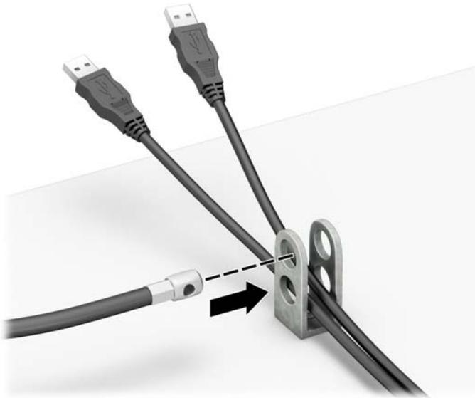
8. Atornille el bloqueo al chasis utilizando el tornillo suministrado (1). Inserte el extremo del cable de seguridad en el bloqueo (2) y presione el botón (3) para activar el bloqueo. Utilice la llave suministrada para desactivar el bloqueo.
