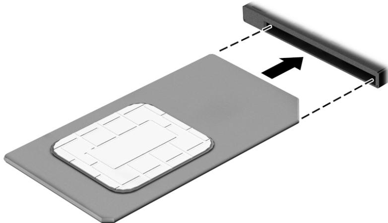
要移除 SIM 卡，请向里按 SIM 卡，然后从插槽中将它移除。
