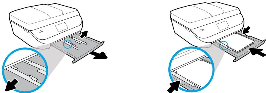
トレイを引き出し、ガイドを外にスライドします。用紙の束を挿入し、ガイドを調整した後、トレイを押し込みます。
