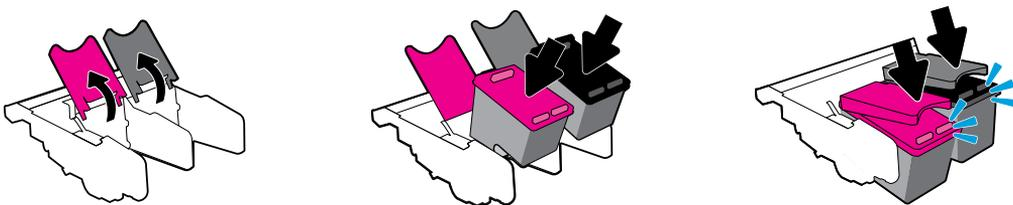
ラッチを開いて、カートリッジを挿入し、ラッチを閉じます (カチッという音がします)。
